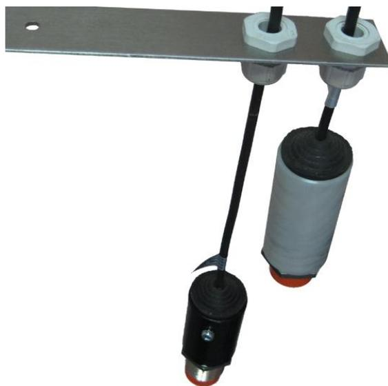
Кабель питания датчика пропускается через отверстие пластикового сальника, закреплённого на алюминиевой пластине. Протяжкой кабеля устанавливается требуемая глубина погружения датчика. Сальник затягивается. Алюминиевая пластина закрепляется на стенке или в горловине ёмкости.
