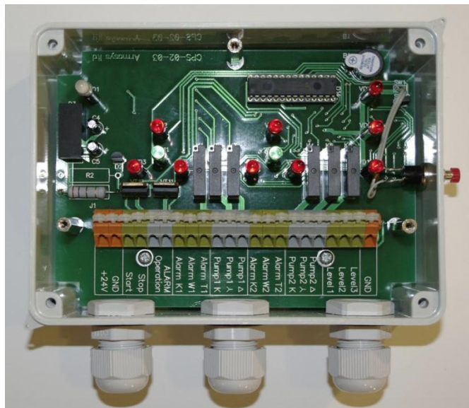
Рис.2. Внутреннее устройство контроллера CPS-02-03
